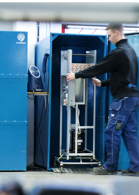
1. Läckagetest efter köldmediefyllning
