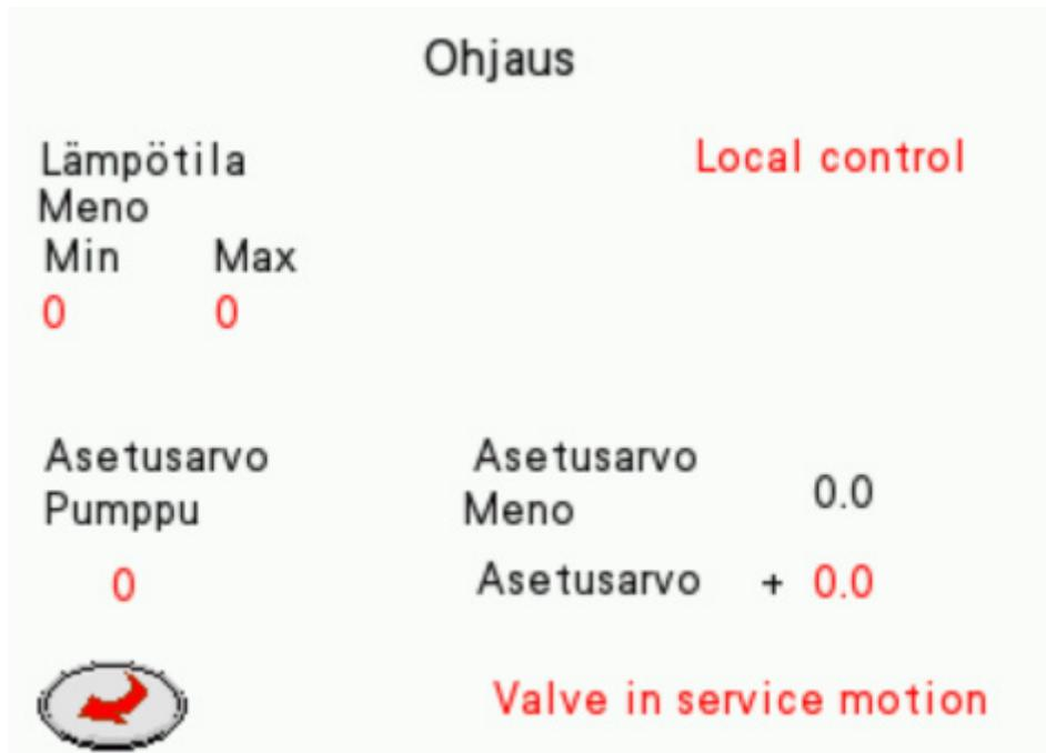
3. Kun "Local Control" on käytössä, järjestelmä toimii paneelin parametreilla osoitteenvaakunalla ezecontrol.com sijasta
