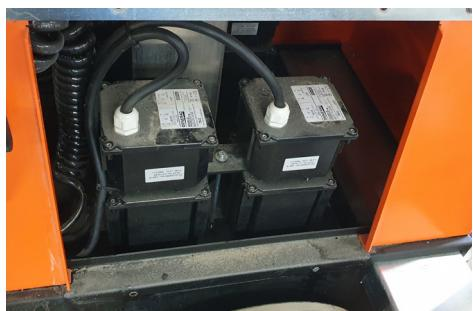
4. Demontera kopplingsdosan på kronan (lät plåten bakom kopplingsdosan sitta kvar). Montera armaturerna på kronan. Avlägsna den fyrkantiga snabbkopplingen (Harting) på spiralkabeln.
