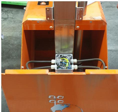
2. Avaa kytkentäkotelo ja irrota kaikki painolasteihin menevät kaapelit. Kytke sisääntuleva kaapeli lähtevään kierrekaapeliin, joka on vedetty ylös mastoon kytkentäkoteloon tai pikaliittimellä (maa-, vaihe- ja nollajohdin ylhäällä mastossa).
