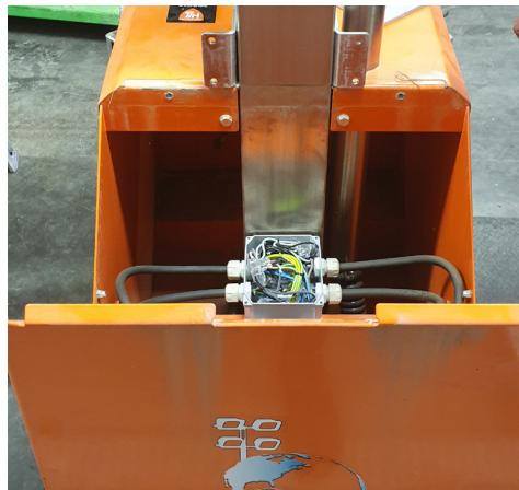
2. Åpne koblingsboksen og koble bort alle kabler til ballaster. Koble sammen innkommende kabel med utgående spiralkabel som er trukket opp i masten i koblingsboksen eller med hurtigkobling (jordleder, faseleder og nøytralleder videre opp i masten).
