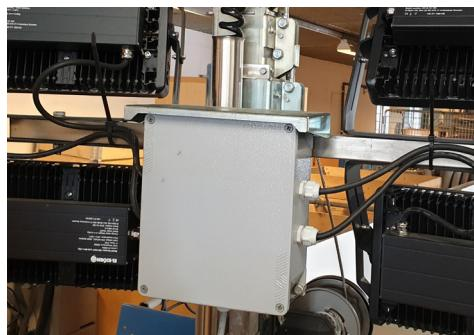
5. Asenna uusi pikaliitin (naaras) kierrekaapeliin (ks. kuva oikealla). Tarkista, että oikeat johtimet on liitetty pikaliittimeen. Liitä valaisinkaapeli Y-liittimeen.
