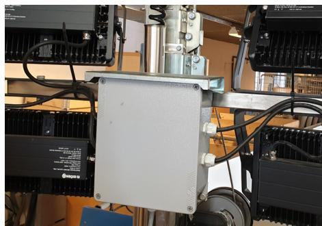
5. Montera en ny snabbkoppling (hona) på spiralkabeln (se bild till höger). Kontrollera att korrekt ledare är anslutna till snabbkopplingen. Anslut armaturkabeln till Y-kopplingen.
