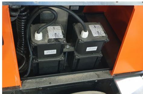
4. Demonter koblingsboksen på kronen (la platen bak koblingsboksen bli sittende). Monter armaturene på kronen. Fjern den firkantede hurtigkoblingen (Harting) på spiralkabelen.
